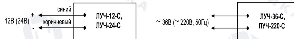
Рис.1. Схемы подключения.
